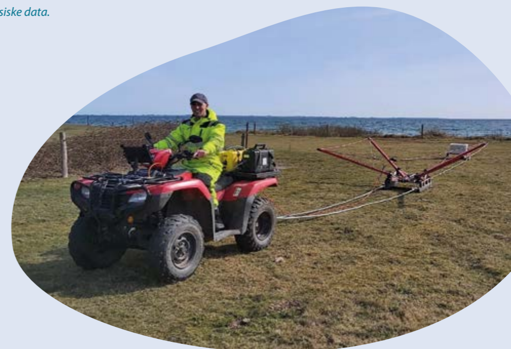
ttTEM-systemkortlægning på øen Endelave.
