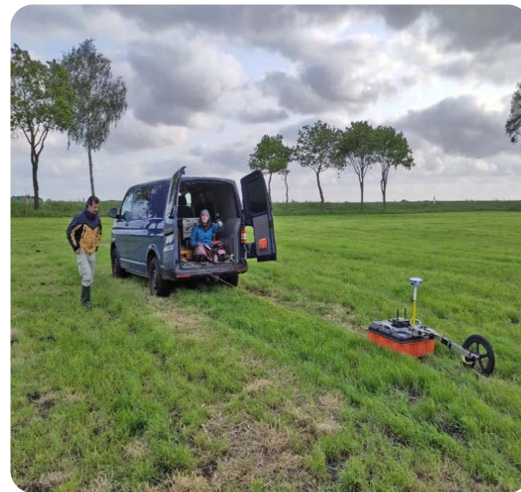
GPR System zur Untersuchung der Moormächtigkeit.
